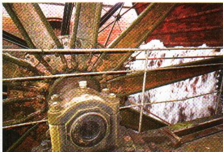
Mühlräder erzeugen die Wasserkraft für die Zugseile
