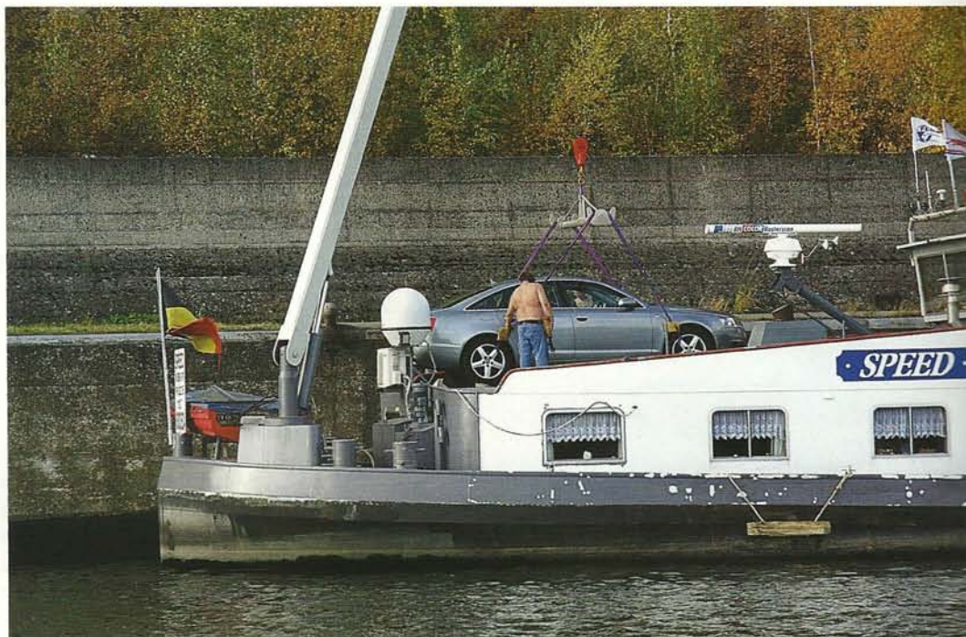
Auto ładuje na brzegu z pomocą dźwigu
