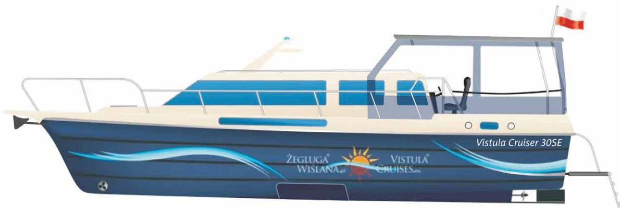
Vistula Cruiser 30 SE wersja z silnikiem stacjonarnym i wałem napędowym + sterem strumieniowym na dziobie oraz osłoną kokpitu version with inboard engine with shaft + bow thruster and sun awning
